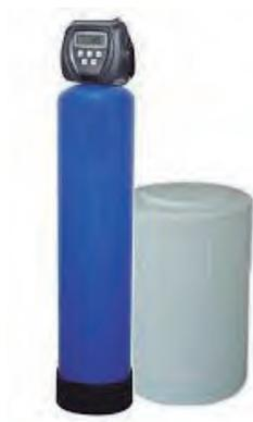
Descalcificador con válvula clack WS 1 UF . Con regeneración contracorriente. Contador para el control del volumen de agua tratada..Sistema regulador de dureza integrado. Presión de trabajo: 2,5 a 6 bar.
