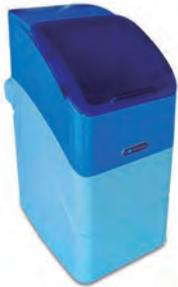
Descalcificador de agua Kinético con un caudal de trabajo de 2,1 m<sup>3</sup>/h y funcionamiento volumétrico sin electricidad. La válvula de sal que lleva incorporado va con flotador de seguridad y permite el ajuste de la frecuencia de regeneración según la dureza del agua d entrada.
